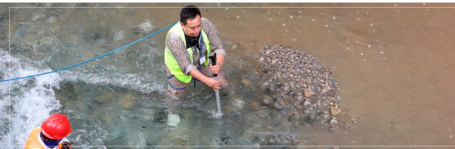
Ilustración 8 Medición del caudal del río Canlich.
