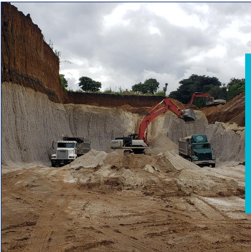
Extracción mecanizada de piedra pómez en una cantera ubicada en el municipio de Villa Nueva del departamento de Guatemala.
