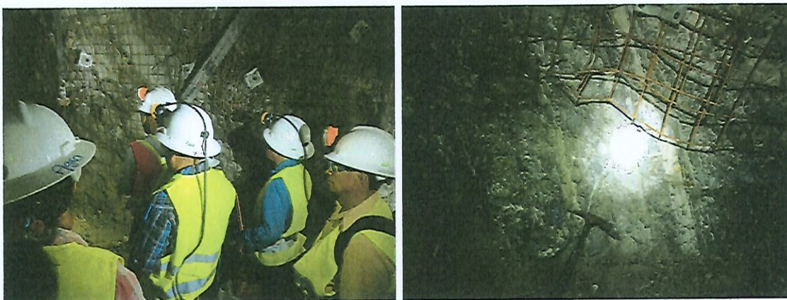
Fotografía No. 15 y 16. Muestra el levantamiento estructural realizado por el asesor del Pueblo Xinca y la veta mineralizada constituida de sulfuros.
