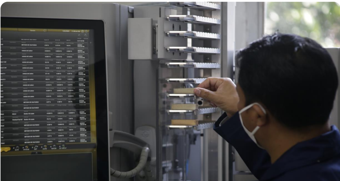
Equipo CNS, equipo utilizado para determinar la composición de carbono, nitrógeno y azufre en muestras de hidrocarburos y muestras minerales.
